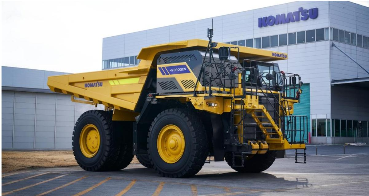
**Die Argo-Anleg GmbH stellt eine entscheidende technologische Komponente für ein wegweisendes Wasserstoffprojekt bereit. Der Münchner Wasserstoffexperte KEYOU und der zweitgrößte Baumaschinenhersteller<sup>1)</sup> der Welt, Komatsu mit Sitz in Japan, haben gemeinsam den weltweit ersten 12-Zylinder Wasserstoffmotor (ICE) für einen großen Muldenkipper entwickelt.**
